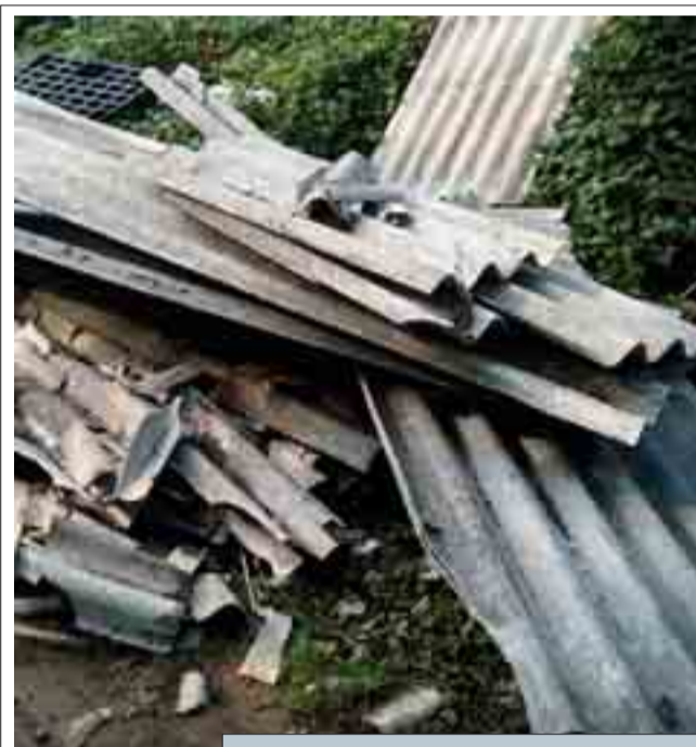
DISCARICA ABUSIVA di amianto nei boschi
